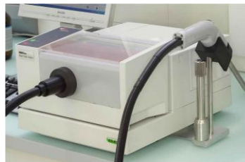
NIRFlex Száloptika modul szilárd mintához
